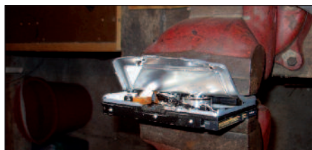
Obr. 2 Vyjmutí ploten pevného disku
