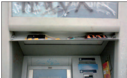
Obr. 2 Odhalený panel s kamerou, dole vpravo falešný vložený nástavec
