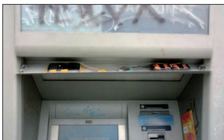
Obr. 2 Odhalený panel s kamerou, dole vpravo falešný vložený nástavec
