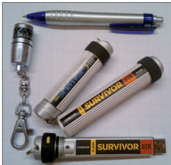
Obr. 1 Příklady fyzicky velice odolných flash stíků (voda, oheň, náraz). Z hlediska autorovy zkušenosti je nejlepší prostřední (32 GB); bohužel nemají ani hardwarové šifrování ani klávesnici.
